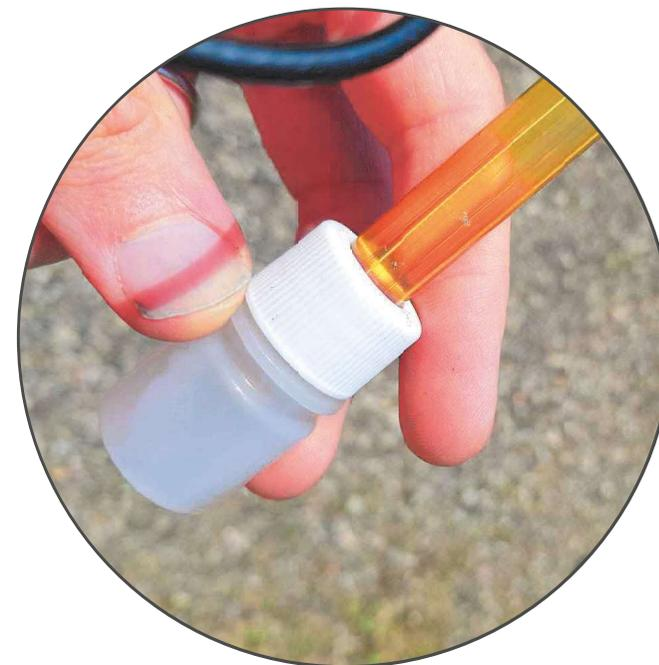
Retirer avec précaution la protection de la sonde de pH et placez les sondes dans le bassin.
