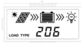
Sous l'interface du mode charge, appuyez sur le bouton ENTRÉE et maintenez-le enfoncé 5 s jusqu'à ce que le nombre clignote, puis appuyez sur le bouton SELECT pour définir les paramètres, et appuyez sur le bouton ENTRÉE pour confirmer.
