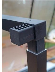
Placez les tubes de 350mm à la vertical et les fixer dans les connecteurs.
