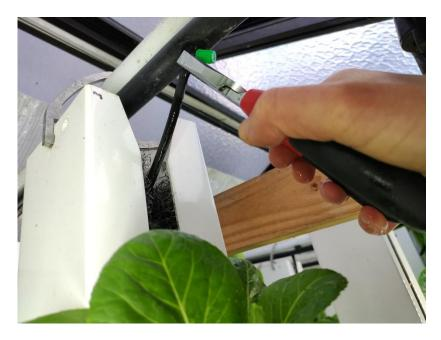
Utiliser de nouveau la pince pour insérer cette fois la nouvelle buse dans le tuyau d'irrigation.
