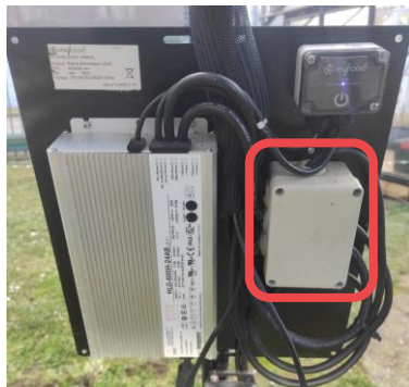
Emplacement du boîtier de dérivation sur la platine d'alimentation
