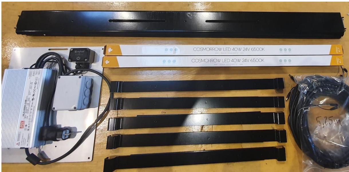
Figure 1. Composants du kit LED (platine d'alimentation, montants bacs perma, barres LEDs, câbles°
