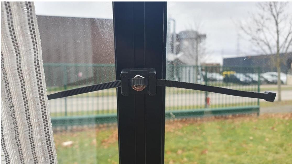
Figure 4. Assemblage attache-câble avec vis en T et rondelle
