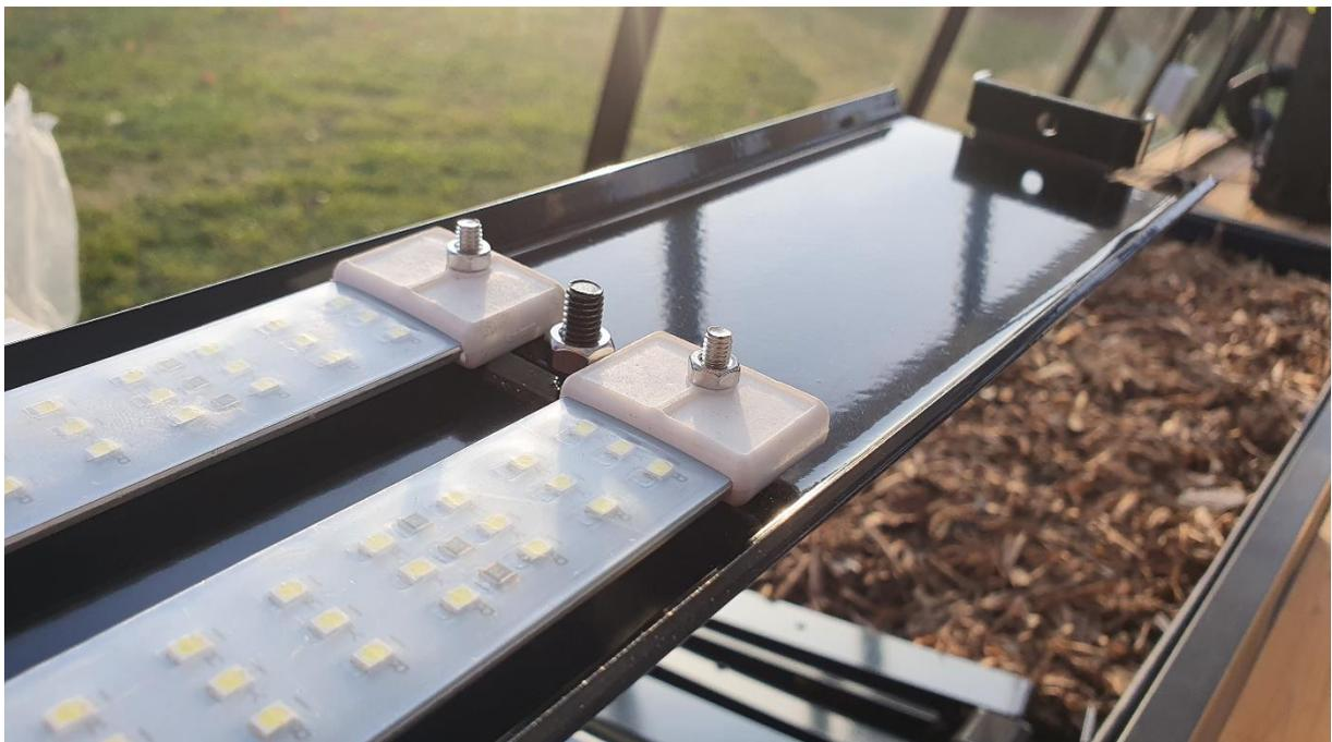
Figure 15. Assemblage des barres LEDs sur la structure des bacs perma 2
