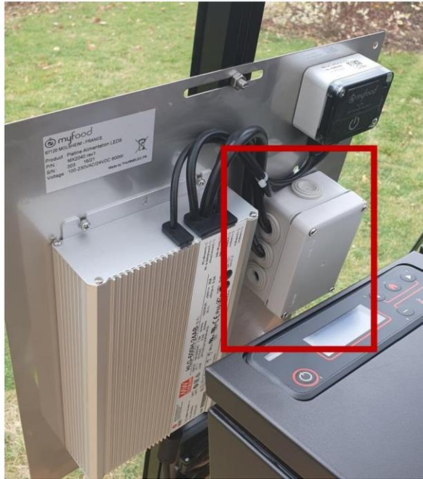
Figure 18. Emplacement du boîtier de dérivation sur la platine d'alimentation
