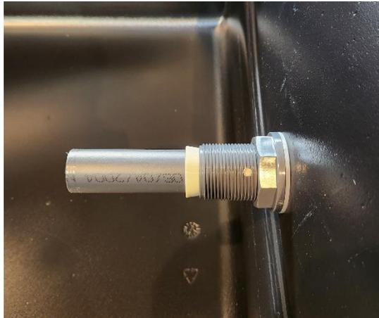
6. Serrer l'olive en plastique (4) sur le tube avec l'écrou tube (6)
