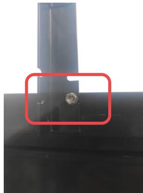
*Support en butée sur l'écrou*
